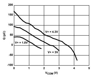
FIGURE 17. CHARGE INJECTION vs SWITCH VOLTAGE
