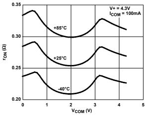
FIGURE 12. ON-RESISTANCE vs SWITCH VOLTAGE
