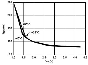
FIGURE 19. TURN-ON TIME vs SUPPLY VOLTAGE
