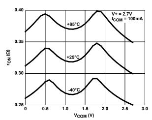
FIGURE 14. ON-RESISTANCE vs SWITCH VOLTAGE
