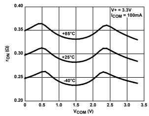
FIGURE 13. ON-RESISTANCE vs SWITCH VOLTAGE
