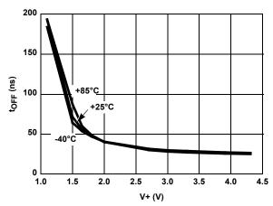
FIGURE 20. TURN-OFF TIME vs SUPPLY VOLTAGE
