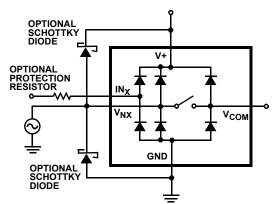
FIGURE 8. OVERVOLTAGE PROTECTION
