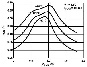
FIGURE 15. ON-RESISTANCE vs SWITCH VOLTAGE
